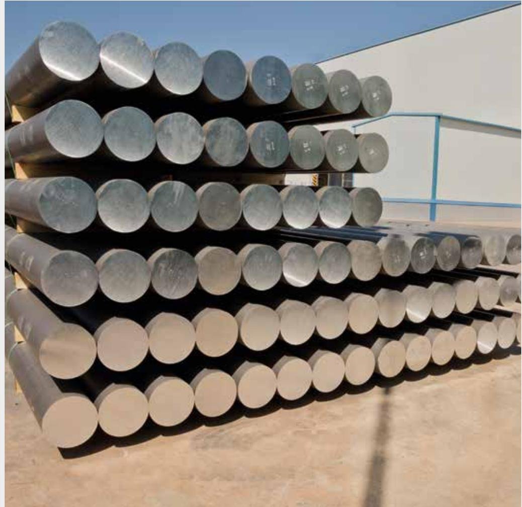
Lingotes cilíndricos también llamados “tochos”, para obtener perfiles de aluminio rectos y eliminar cualquier tensión en el material, se les estira. Luego, se cortan en longitudes adecuadas y se envejecen artificialmente para lograr la resistencia apropiada.
